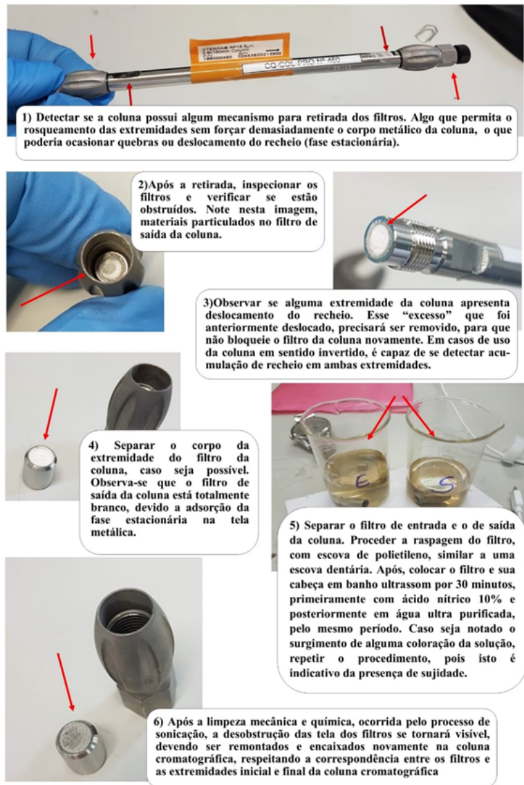
Figura 6. Passo a passo para limpeza do filtro de uma coluna cromatográfica de CLAE.
