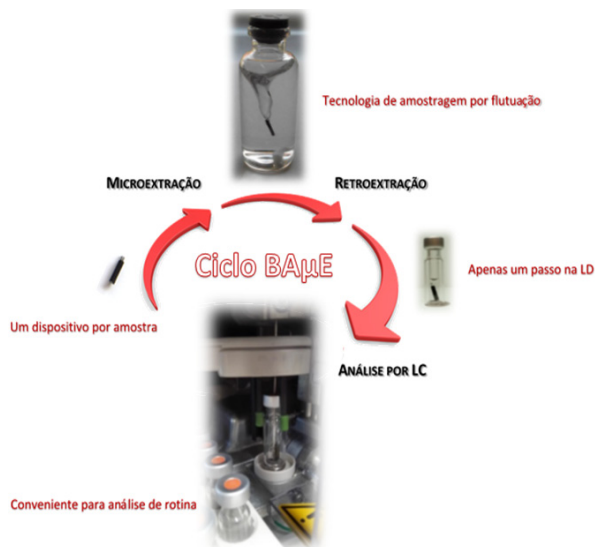
Figura 3. Ciclo analítico inovador introduzido com os dispositivos BA \mu E de última geração. Adaptado da referência 20.
