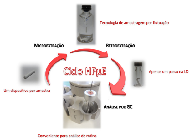
Figura 5. Ciclo analítico inovador introduzido com os dispositivos HF \mu E. Adaptado da referência 21.
