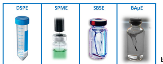
Figura 1. Imagens dos dispositivos e aparatos analíticos, relativos às principais técnicas de microextração estática baseadas em fases líquidas (a) e sólidas (b), atualmente mais usadas em análise vestigial.
