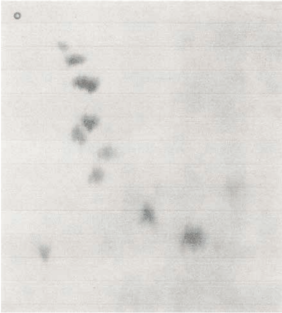
Figura 6. Cromatograma em duas dimensões do trabalho de Martin e colaboradores 3 .
