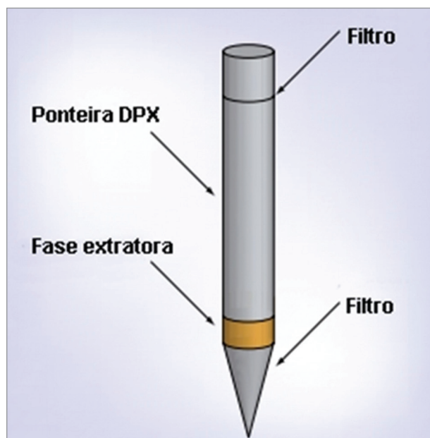
Figura 1. Esquema de uma ponteira DPX [Adaptado da referência n 7].
